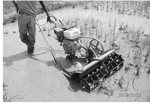
写真-4 国際稲研究所（IRRI）が開発した小型代かき機
